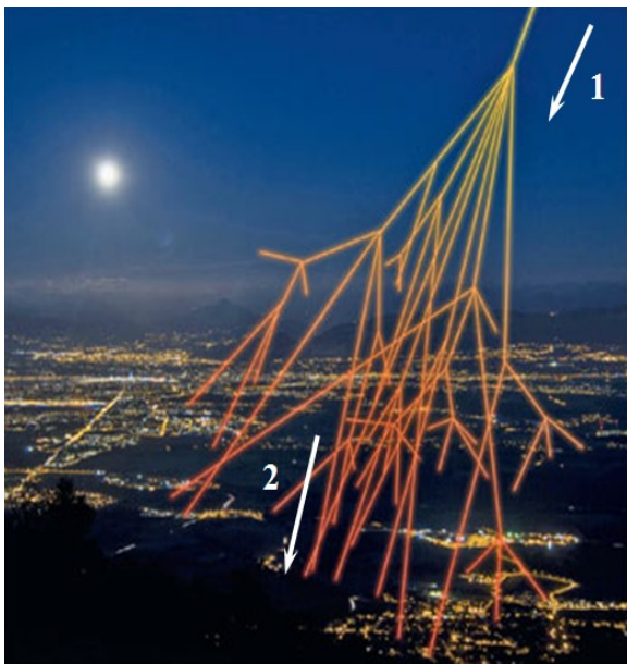
Рис.6. Несоответствие направлений прилёта частицы первичных КЛ (1) и направления регистрации (2) вторичной частицы
