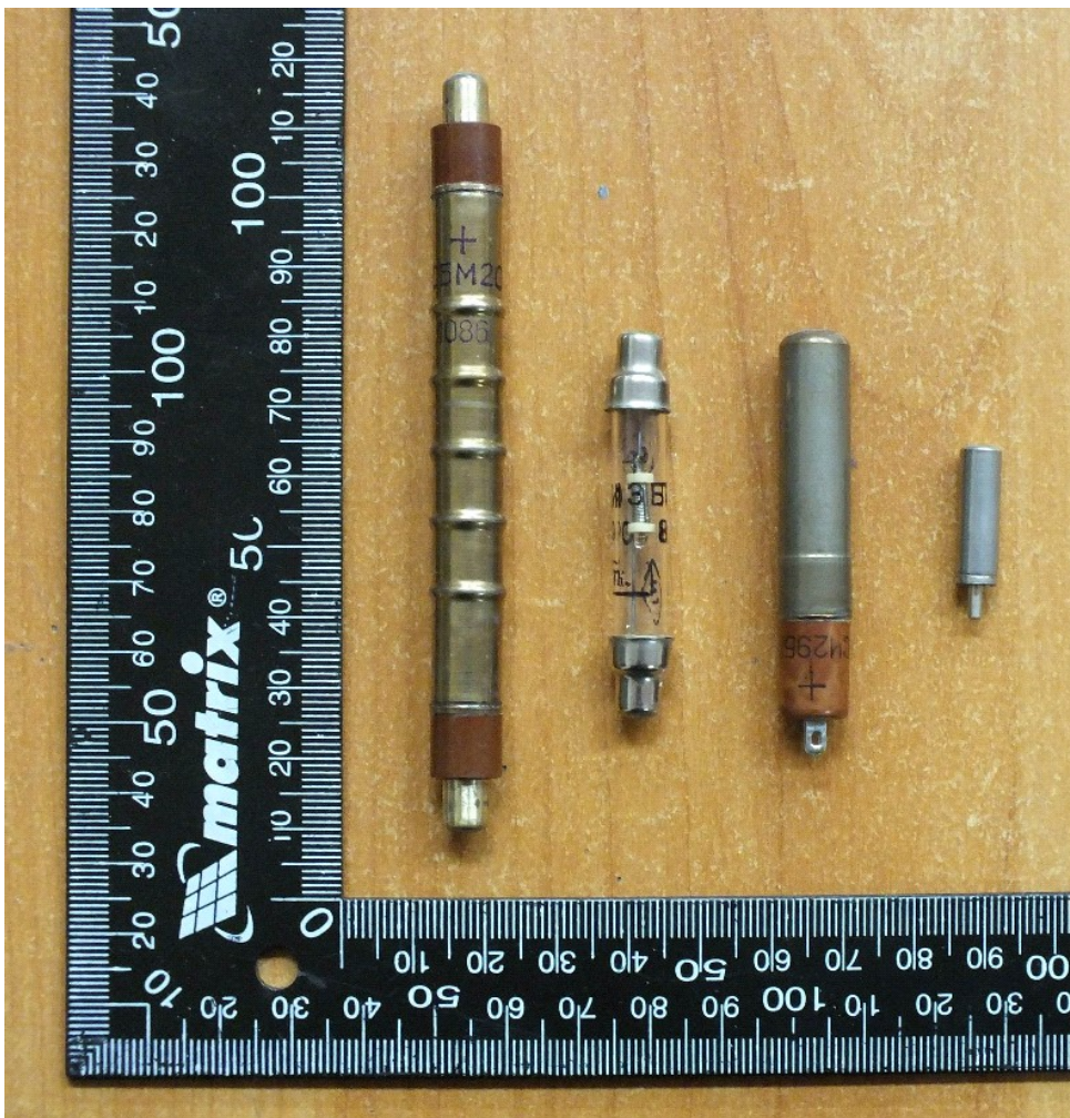
Рис.13. Счётчики Гейгера для СМТКЛ. Слева направо: СБМ-20, СИЗБГ, СИ29БГ, СБМ-10.
