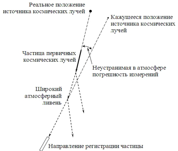
Рис.6. Несоответствие направлений прилёта частицы первичных КЛ (1) и направления регистрации (2) вторичной частицы
